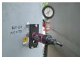
Натурные испытания на объекте (шпилька M10x135, установка в колонну из тяжелого бетона, максимальная нагрузка на вырыв 30,7 кН)
