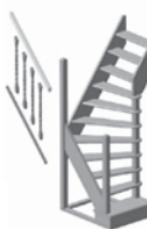
11. На первую нижнюю ступень устанавливаются столб с пазом под нижнюю струну 86x86x1200 мм (поз. 23). Отдельно собирают конструкцию из 4 балясин с углом 48 градусов (поз. 25), их основания и поручня (поз. 24 и 26).
