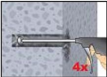
**Nach der Reinigung ist das Bohrloch bis zum Injizieren des Mörtels vor erneutem Verschmutzen in einer geeigneten Weise zu schützen. Ggf. ist die Reinigung unmittelbar vor dem Injizieren des Mörtels zu wiederholen. Einfließendes Wasser darf nicht zur erneuten Verschmutzung des Bohrloches führen.**
