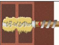
7. Vor dem Einsetzen der Ankerstange ist die Verankerungstiefe auf der Ankerstange zu markieren. Befestigungselement mit leichten Drehbewegungen bis zur festgelegten Setztiefe eindrücken. Die Ankerstange muss schmutz-, fett-, und ölfrei sein.
