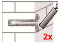
4. Bohrloch vom Bohrlochgrund her zweimal ausblasen. Die Stahlbürste in eine Bohrmaschine oder einen Akkuschauber einstecken, das Bohrloch zweimal ausbürsten und abschließend erneut zweimal ausblasen.
