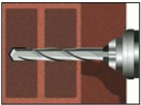
3. Das Bohrloch, senkrecht zur Oberfläche des Verankerungsgrundes, mit Bohrverfahren nach Anhang C4-C34 mit vorgeschriebenem Bohrerenddurchmesser und Bohrlochtiefe entsprechend der Ankergröße und Einbindetiefe des gewählten Dübels im Verankerungsgrund erstellen. Bei Fehlbohrungen ist das Bohrloch zu vermörteln.
