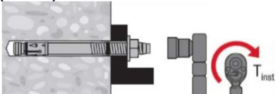
**6b. Используйте гайковерт с модулем контроля затяжки (M8-M12)**
