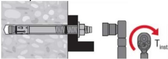
**4b. Используйте гайковерт с модулем контроля затяжки (M8-M12)**
