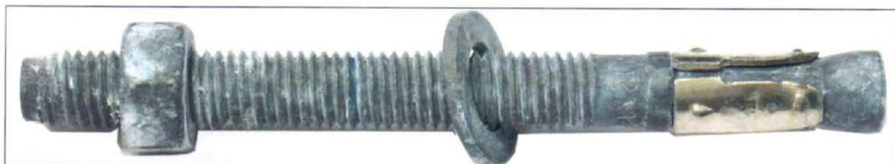
Рис. 2 Внешний вид анкера с термодиффузионным цинковым покрытием после испытаний в камере соляного тумана в течение 500 ч
