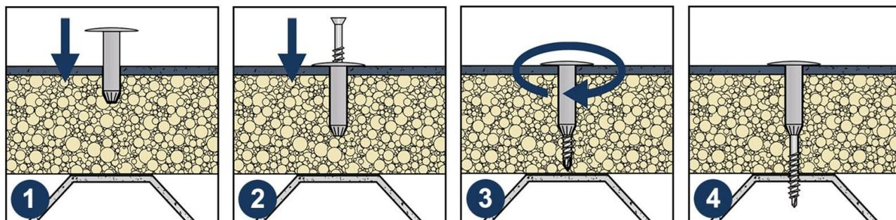
\* Шуруп подбирается по формуле  $LШ = LT - LД + 30$  ( $LШ$  — длина шурупа, мм;  $LT$  — толщина кровельного пирога (теплоизоляция + гидроизоляция), мм;  $LД$  — длина кровельного тарельчатого дюбеля, мм.)
