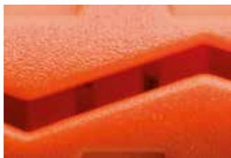
**Контролирующие перемычки** предотвращают раскрытие дюбеля в процессе предварительной установки. Легко разрываются при вворачивании шурупа, обеспечивая полное раскрытие дюбеля.
