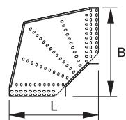
Секция угловая 90° предназначена для поворота трассы, выполненной из листовых лотков в горизонтальной плоскости на 90°. Секция имеет плавный изгиб, что позволяет свести на минимум возможность повреждения кабеля при проведении монтажных работ.
