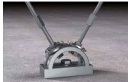
Установка растяжек с помощью UHRS
